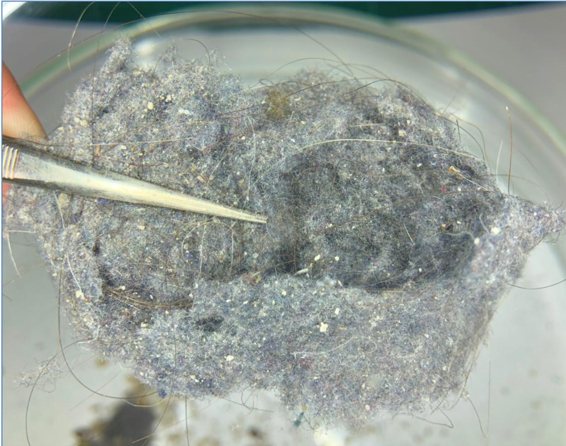
**Abbildung 31: Sicht auf Fasern einer Probe unter der Lupentischlampe (zweifache Vergrößerung)<sup>77</sup>**
