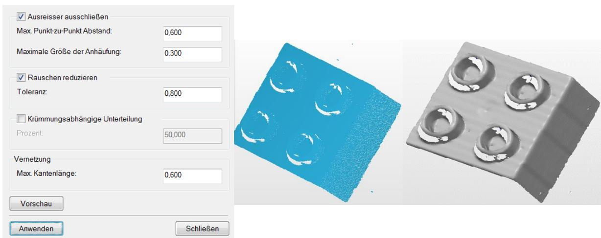
Abbildung 7-1: Einstellung der Vernetzung (links), Punktwolke (mittig), vernetzte Oberfläche (rechts)
