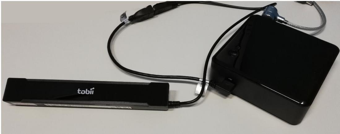
Abbildung 5.1: Tobii X60 Eye-Tracking-Einheit (links) und externe Prozessor-Einheit (rechts)
