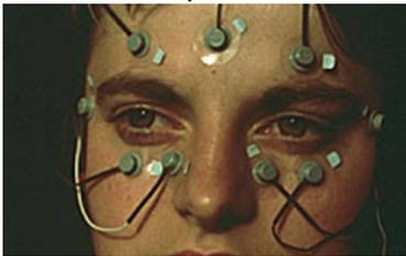
Abbildung 2.1: EOG-Proband mit angebrachten Elektroden. Foto: Duchowski (2017)
