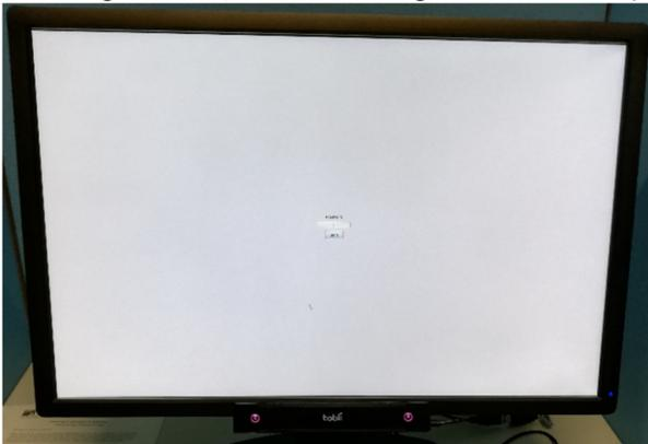
Abbildung 2.4: Video-basierte Messungen von Pupillen- und Hornhautreflektionen-Monitor mit Sensoreinheit am unteren Monitorrahmen
