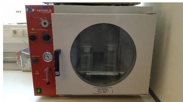
*Abbildung 6 Versuchsaufbau im Heizschrank: Abgebildet sind die sechs verwendeten Glasflaschen im verwendeten Heizschrank.*
