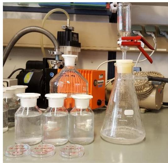
Abbildung 7 Im Versuch verwendete Filtrierapparatur bestehend aus: Trichter, Kernporenfilter, Stützfilter, Fritte, Auffangbehälter, Zange und Saugpumpe.
