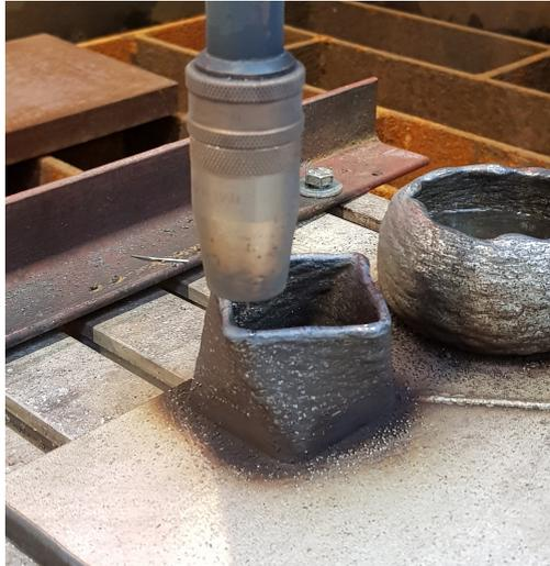
Abbildung 1.4: 3D Druck an der HAW
