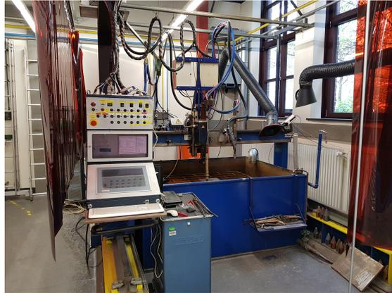
Abbildung 1.1: Metallschutzgasschweißanlage an der HAW Hamburg
