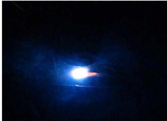
Abbildung 3.1: Schweißprozess beim Metallschutzgasverfahren
