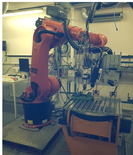
Abbildung 1.2: Laserschweißanlage an der HAW Hamburg
