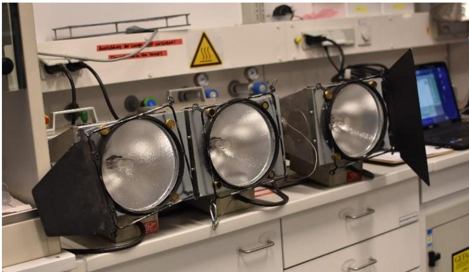
Abbildung 6: Philips MSR 575 HRCT Metall Halogen Lampen für die Beleuchtung der Mikroalgen im Kultivierungsbecken.
