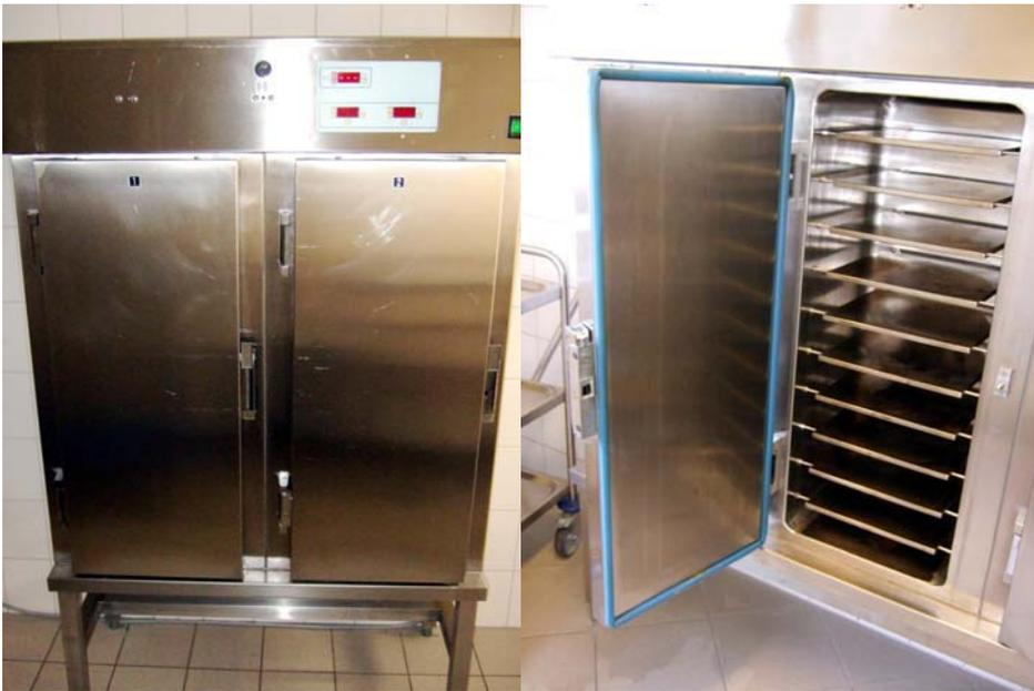
**Abbildung 14: Regeneriergerät Außen- und Innenansicht<sup>126</sup>**
