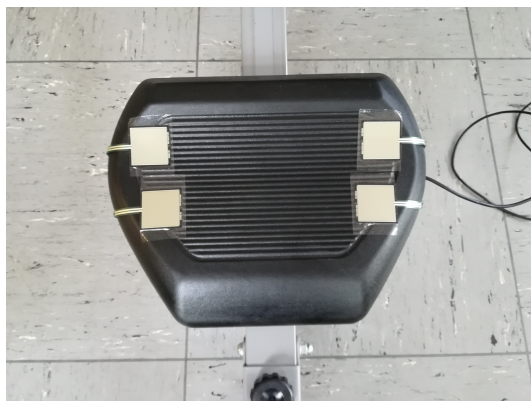
Abb. 4.8: Verteilung der Sensoren auf dem Sitz des Rudergerätes
