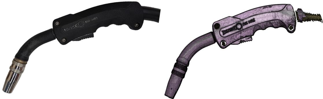
Abbildung 3.23: Durch optische Vermessungsmethoden erstellte Netzansicht für die CAD-Konstruktion
