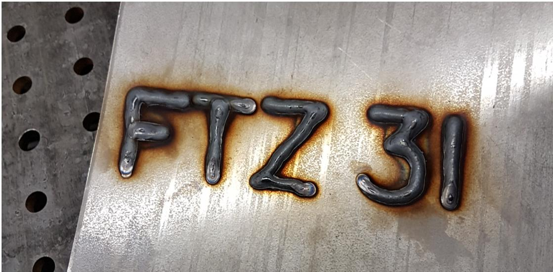
Abbildung 4.5: Schweißergebnis einer komplexen Struktur während des Validierungsexperiments zur Roboter-Mensch-Interaktion
