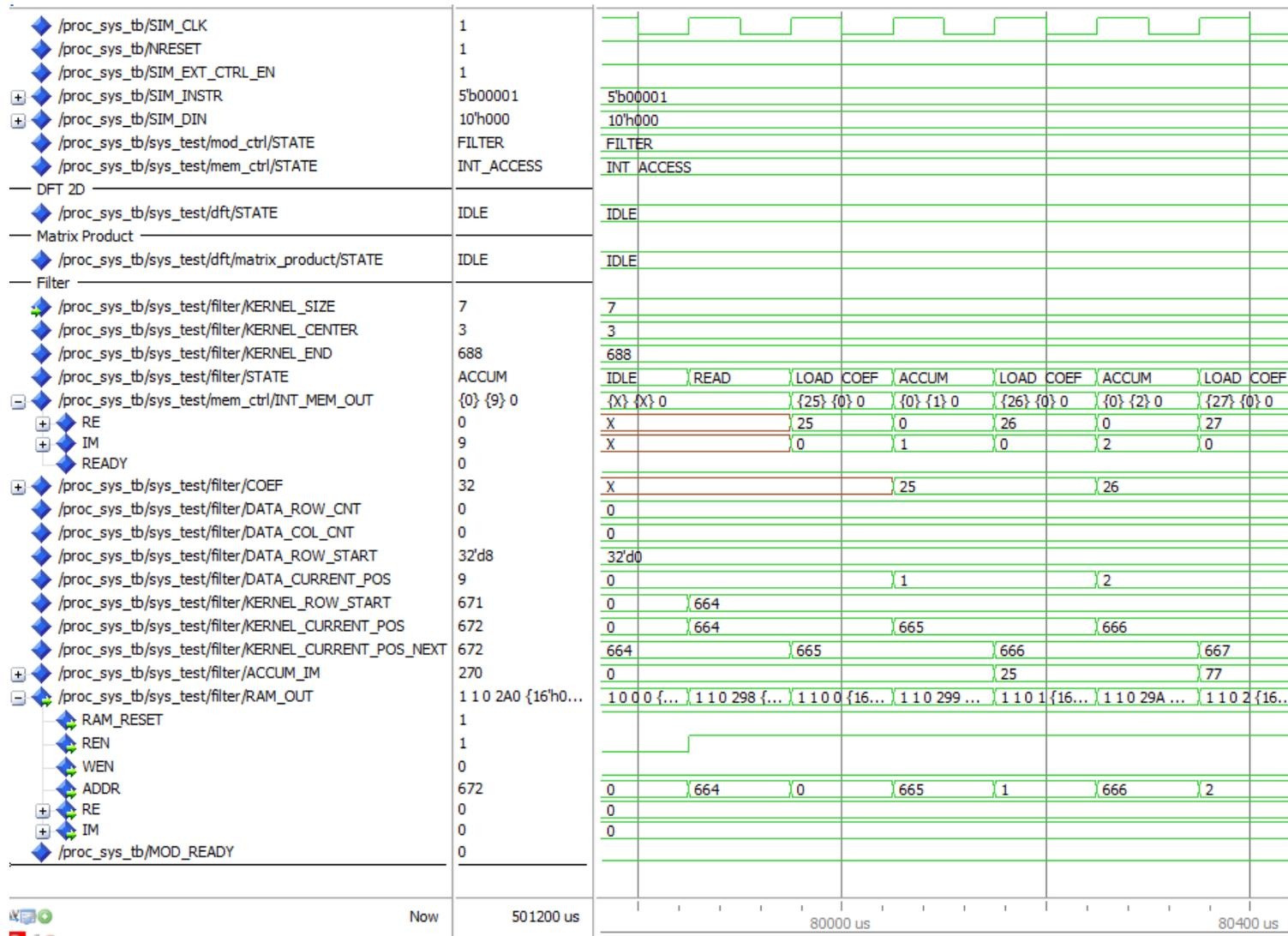
Abbildung B.36: Signalablauf-Diagramm der Simulation der Architektur CONV\_RAM von filter\_conv, 79800-80400 μs
