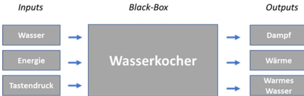
**Bild 2.2** Beispiel für einen Aufbau einer Black-Box
