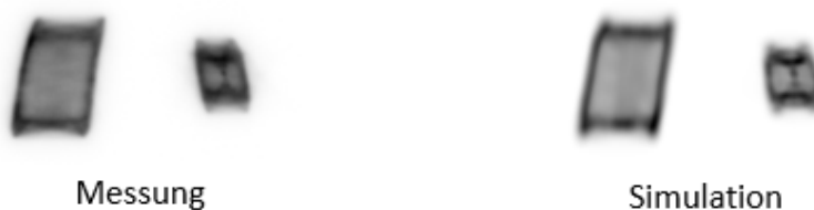
Abb. 10: Vergleich von gemessenen(links) und simulierten Brennfleck (rechts) einer Röntgenröhre mit zwei unterschiedlichen Foki (Eigendarstellung)
