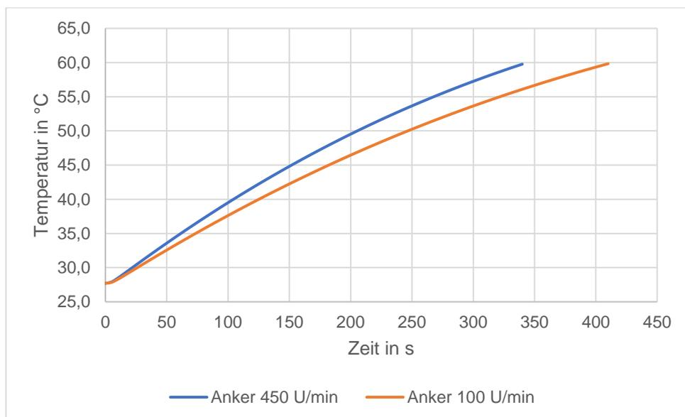
Abbildung 4.16: Vergleich der Programmergebnisse des Ankerrührers im Reaktor 1, Mantelbeheizt
