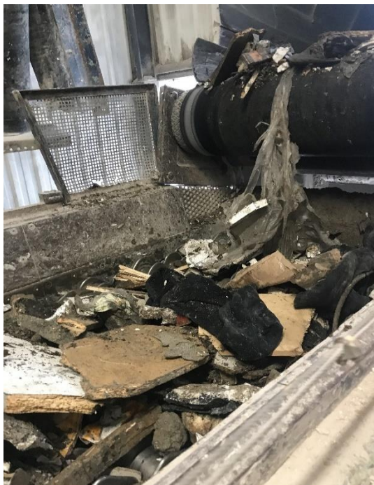
Abbildung 44: Abfallgemisch kleiner als 60 cm wird über ein Laufband auf das Rüttelsieb befördert [52]
