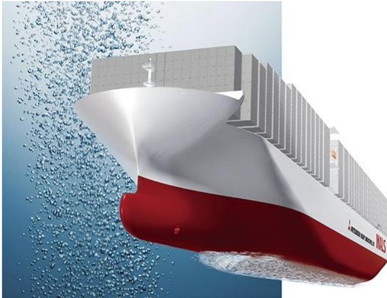
Abbildung 10: Mitsubishi Air Lubrication System
