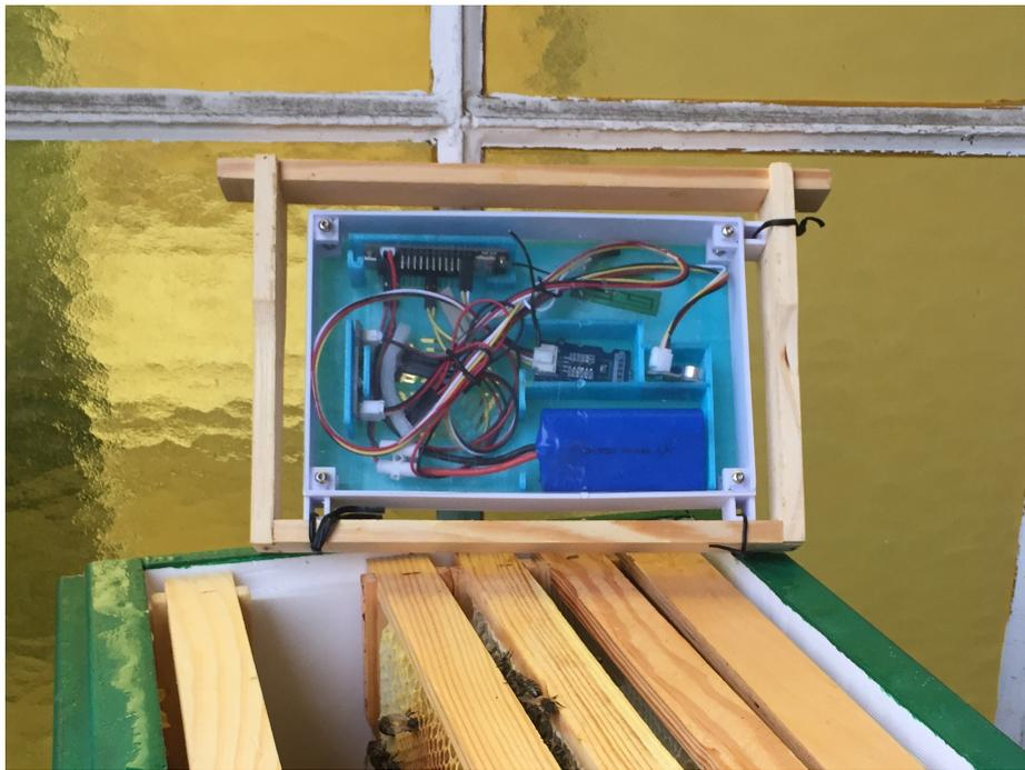
**Abbildung 7.1:** Fertiger Prototyp an einem Rähmchen befestigt
