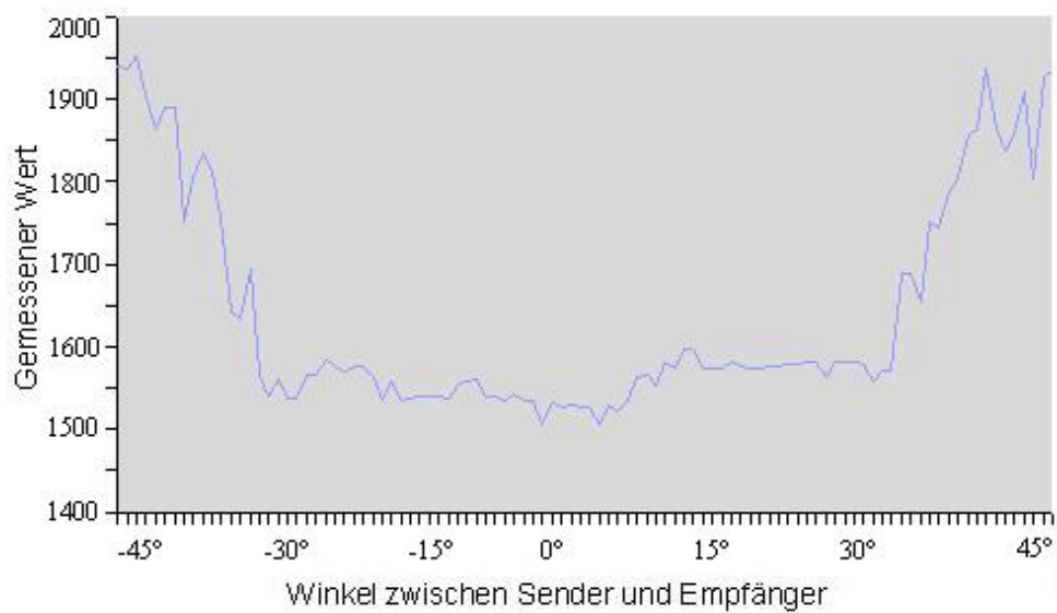
Abbildung 6.4: Einfluss der Orientierung des Empfangsmodules zum Sender. Der empfohlene 60° Winkel liegt zwischen -30° und 30° auf der X-Achse
