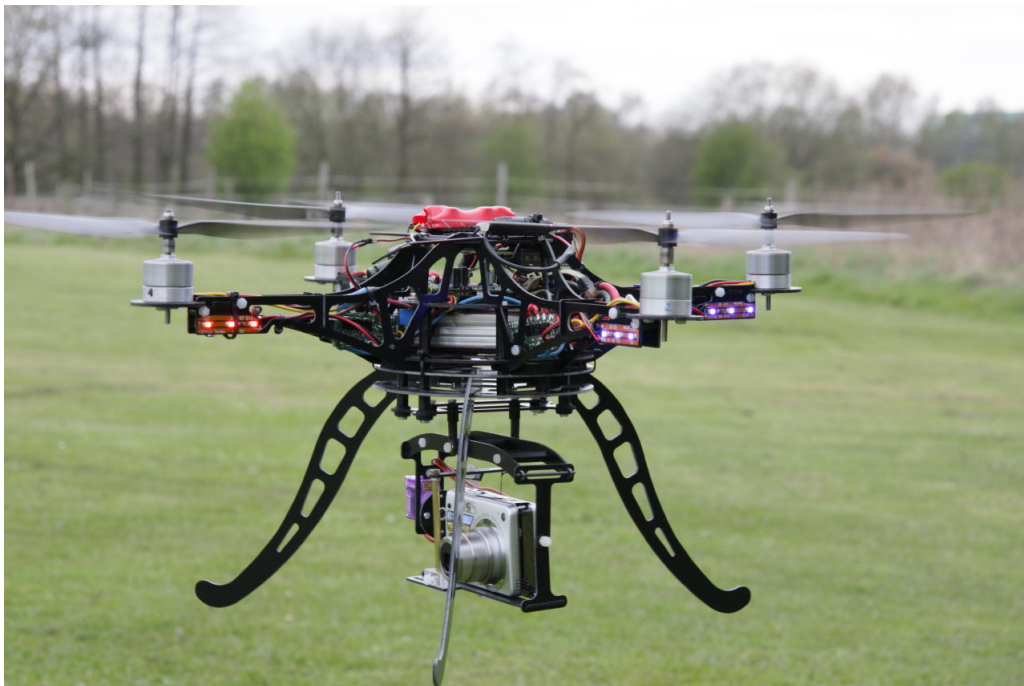
Abbildung 3.2: Mikrokopter mit Landegestell und Kamerahalterung (Quelle [3])
