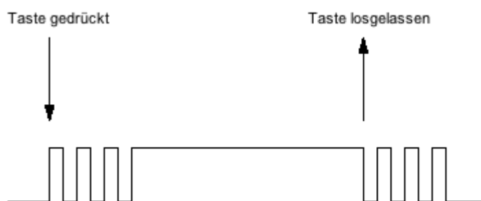
Bild 19: Schematische Darstellung eines Schaltvorganges
