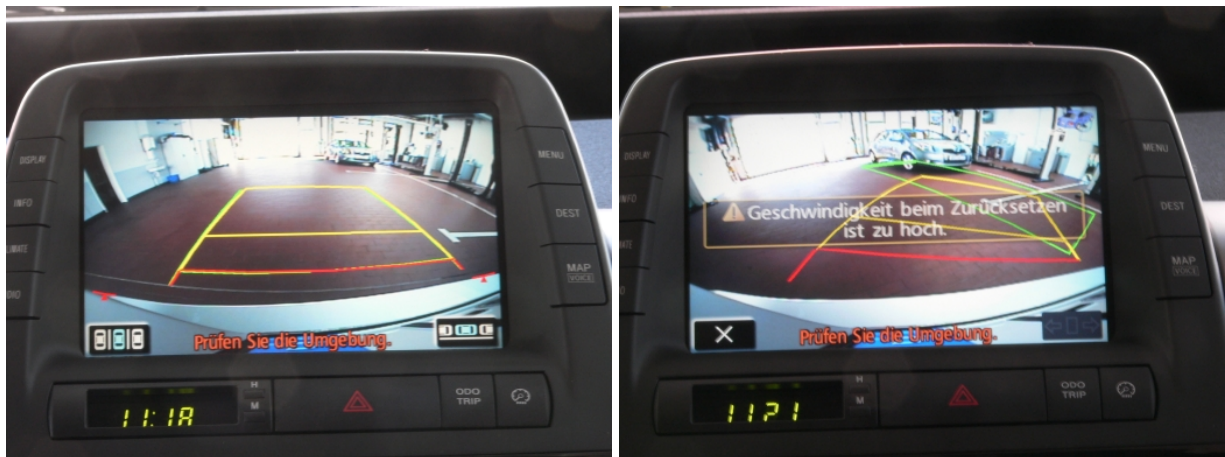
Abb. 4: Einparkvorgang mit Linien zur Abstandsüberwachung. Die horizontalen Linien stellen die Entfernung vom Heck (rot 10 cm, gelbe 20 cm) und die senkrechten Linien die seitliche Begrenzung des Fahrzeugs dar. Ein Warnhinweis erscheint, wenn die Geschwindigkeit zu hoch ist [27].
