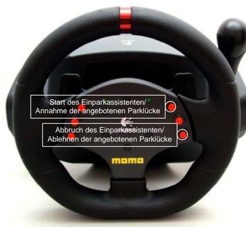
Abb. 27: Lenkrad mit drei Köpfen zum Starten und Abbrechen des Einparkassistenten und zur Annahme oder Ablehnung der angebotenen Parklücke
