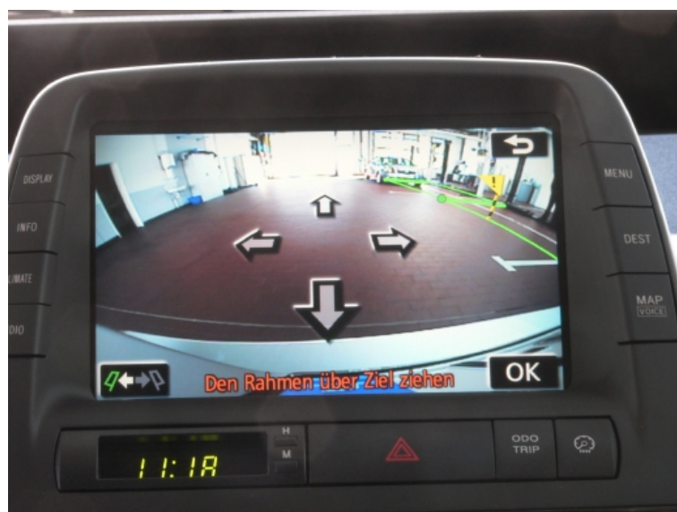
Abb. 3: Bestimmung der Endposition des Einparkvorgangs im IPA, durch Platzierung des grünen Quadrates mit den Pfeilen auf dem Touchscreen [27].
