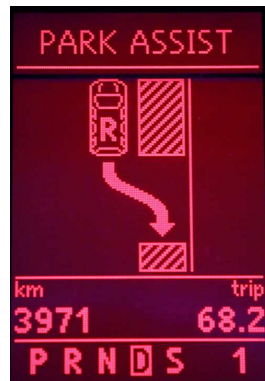
Abb. 6: Nach dem Schalten in den Rückwärtsgang übernimmt Park Assist die Lenkung für den Einparkvorgang. [28]
