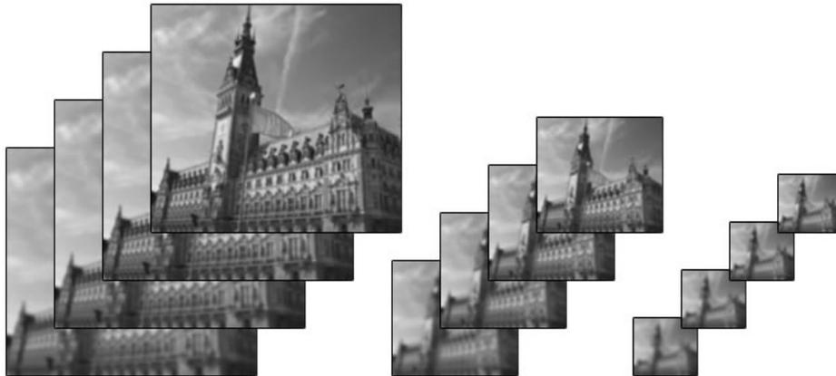
Abbildung 3.2.: Die im SIFT-Verfahren verwendete Gaußpyramide mit mehreren Bildern pro Stufe.
