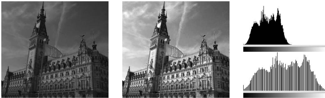
Abbildung 2.1.: Links das „dunkle“ Bild mit dem zugehörigen Histogramm rechts oben. Das mittlere Bild zeigt das Ergebnis nach dem Histogrammausgleich, das dazugehörige Histogramm ist rechts unten.
