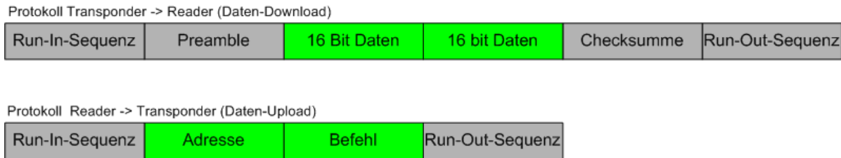
Bild 52: Übertragungsprotokolle zwischen Reader und Transponder
