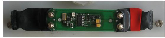
(b) Sensorplatine mit geschützten Anschlussfahnen
