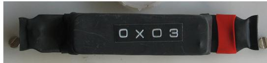
(c) Sensorplatine mit Anschlussfahnen und Schutzschlauch
