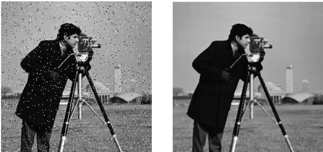
Abbildung 3.2: links verrauschtes Bild, rechts nach einem Tiefpassfilter
