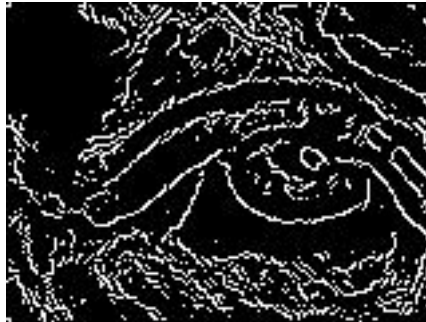
Abbildung 4.12: Kantenbild des Bildes [3.6 S. 40] bei Faltungsmaske: 9x9, Variance: 9,9, Schwellenwert-Max: 0,01, Schwellenwert-Min: 0,8
