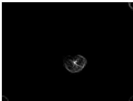
Abbildung 4.20: Der Hough-Raum zur detektierten Pupille des Bildes [4.19 S. 61]
