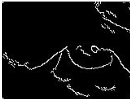
Abbildung 4.14: Kantenbild des Bildes [3.6 S. 40] bei Faltungsmaske: 9x9, Variance: 9,9, Schwellenwert-Max: 0,05, Schwellenwert-Min: 0,8
