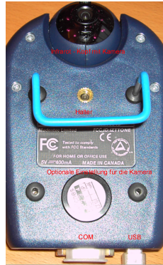
Abbildung 2.10: Die Kamera mit einem beweglichen Kopf und Halter des Tracker One-Systems
