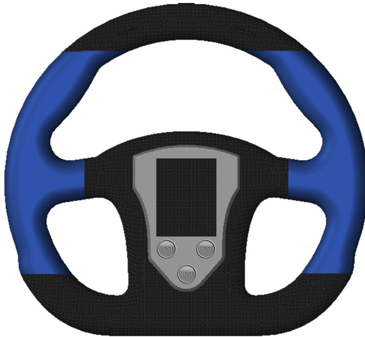
Abbildung 5.3: Anordnung der Knöpfe am Lenkrad unter dem Display
