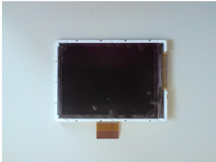
Abbildung 4.4: Das Lenkraddisplay Hitachi TX07D09VM1CBB
