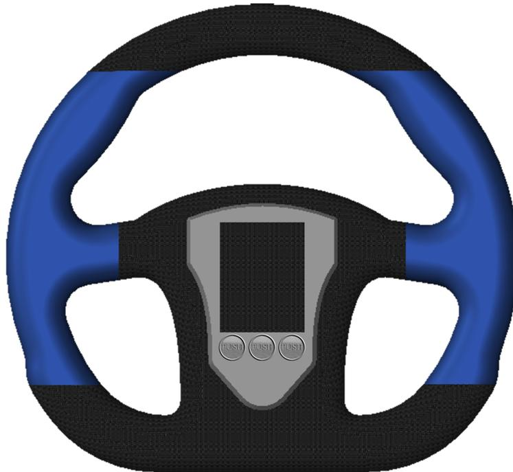
Abbildung 5.2: Anordnung der Knöpfe am Lenkrad unter dem Display auf einer Linie
