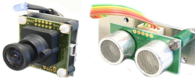
Abbildung 4.2: Eingesetzte Sensorik für das lokale Mapping
