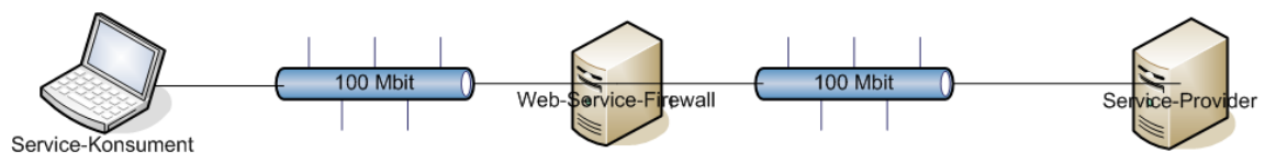
Abbildung 3.2: Versuchsaufbau mit Web-Service Firewall
