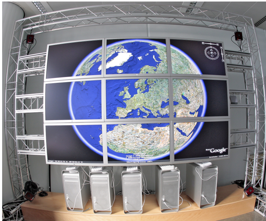
Abbildung 5.1: Powerwall mit Tracker im Ambient-Lab
