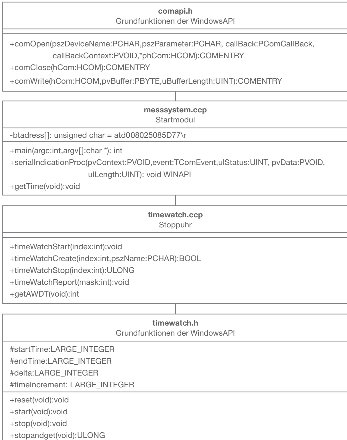
Abb. 4.1 Einfaches Klassendiagramm mit den nötigsten Methoden
