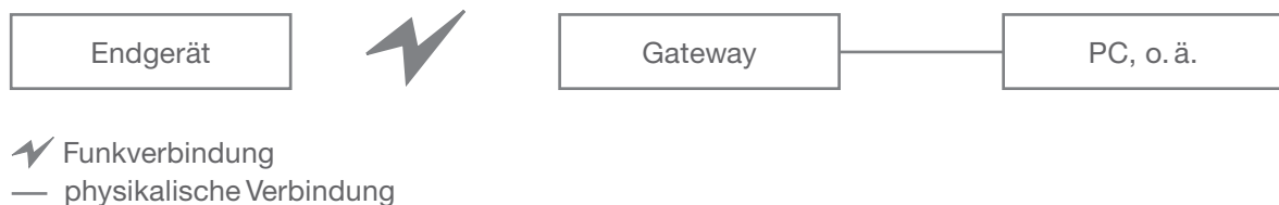
Abb. 2.10 Beispiel für eine Typ 2 Kommunikation
