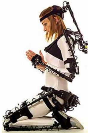
Abbildung 2.5: Mechanisches Motion Capturing von Meta Motion ( Motion (2004) )
