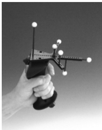
Abbildung 3.6: Der Flystick 1 von A.R.T-GmbH (2008)
