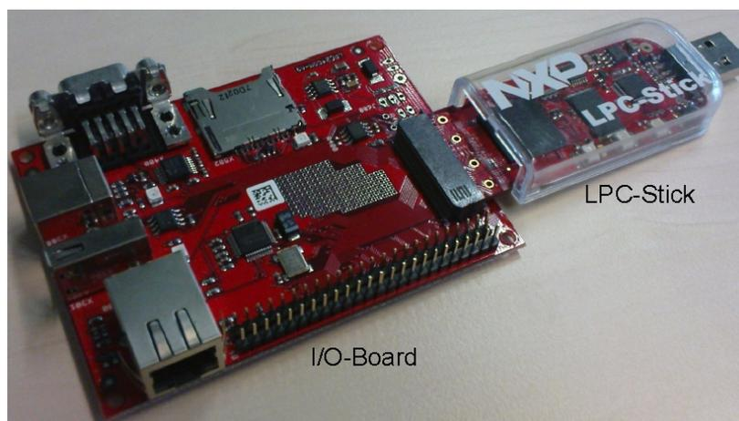
Abbildung 4.7.: ARM7 mit I/O-Board
