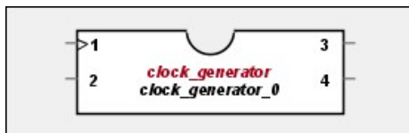
Abb. 6.12: Clock Generator mit Oszillator- und Reset Eingang, Clock und DCM Lock Ausgang.
