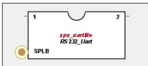
Abb. 6.9: RS-232 Uart mit Anschluss an den PLB, sowie RX- und TX Pins.
