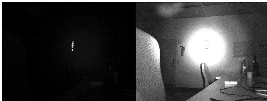
**Abbildung 2.7.** – Auswirkungen der manuellen Wahl der Kameraeinstellungen. Links: Manuelle Einstellung der Kamera. Rechts: Automatische durch die Kamera durchgeführte Einstellungen.
