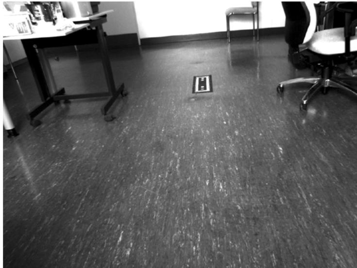
**Abbildung 5.13.** – Erkennung der Marke mit der ID 3 (siehe Tab. 5.3 bei Beleuchtung durch Sonnenlicht) aus einer Entfernung von 2,65 m und einem Winkel von ca. 30° zwischen optischer Achse und Boden. Doppelverhältnis wird auch unter diesem Winkel mit 1,05244 korrekt gemessen.
