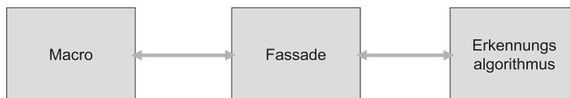
**Abbildung 5.8.** – Struktur des erstellten Macros. Zugriff auf Erkennungsalgorithmus nur über Fassade möglich.
