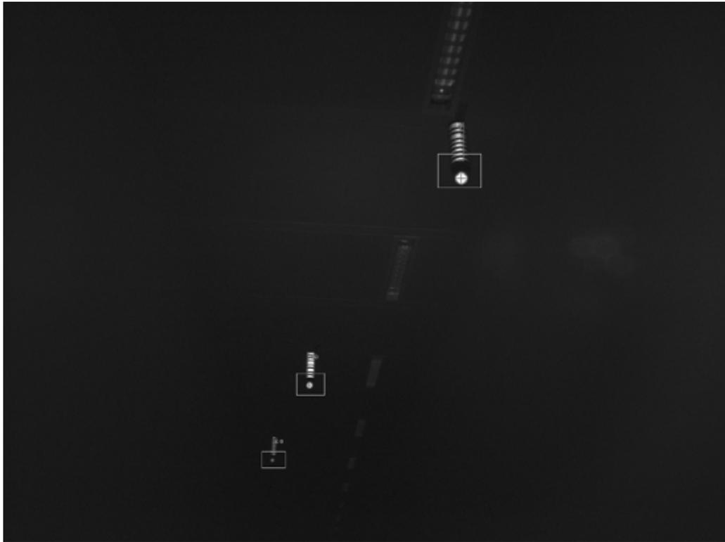
**Abbildung 6.42.** – Einzelbild aus dem abschließenden Vergleichstest der Zylindermarke, in dem alle 3 Marken erkannt wurden.
