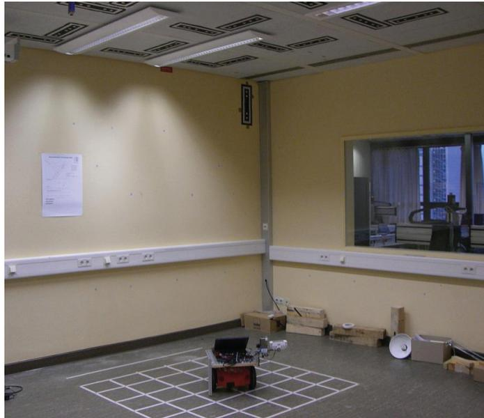
**Abbildung 7.1.** – Testumgebung aus [Manske, 2008a] mit Doppelverhältnismarken und parallel zur Decke ausgerichteter Kamera. Abbildung aus [Manske, 2008a]
