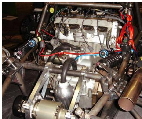
Abbildung 4.1.: Montierter Motor im H04
