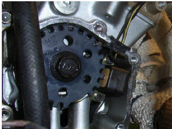
**Abbildung 4.2.:** Geberrad und induktiver Sensor am Motor montiert
