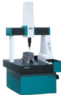
Abbildung 2.1.: 3D-Koordinatenmessmaschine der Firma Wenzel GearTec GmbH. 7
