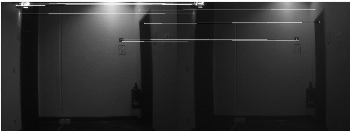
Abbildung 6.6.: Leerer Flur mit SIFT-Punktepaaren (Distanz 5m): Es ist zu erkennen, dass sehr wenige SIFT-Punktepaare gefunden worden sind. Besonders im Bildzentrum sind kaum Punkte vorhanden. Dies ist vor allem auf die gleichmäßige Struktur der Stirnwand und die ähnlichen Grautöne in diesem Bereich zurückzuführen, welche wenig Ansatzpunkte für den SIFT-Algorithmus bieten.
