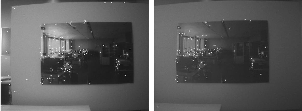
Abbildung 5.11.: Die Fotos zeigen die Aufnahme einer Szene aus der später beschriebenen Genauigkeitsanalyse des SIFT-Verfahren. Die weißen Punkte markieren die gefundenen SIFT-Punkte im Bild der linken und rechten Kamera nach der Verarbeitung durch das Impresario-Projekt.
