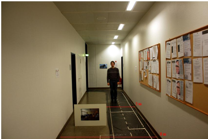
Abbildung 6.8.: Szenario - Flur mit Hindernissen: Um die Situation realer zu gestalten und mehr SIFT-Punkte zu erhalten, werden verschiedene Hindernisse im Flur aufgestellt.
