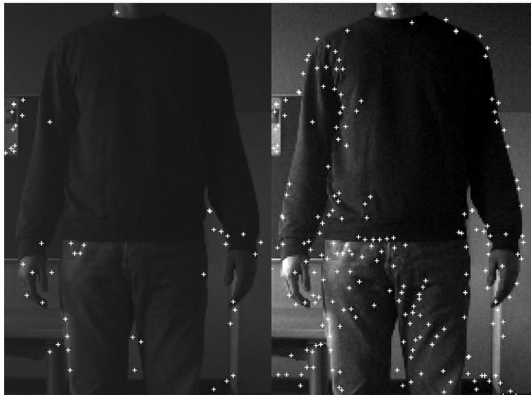
Abbildung 6.23.: Durch den Weißabgleich werden auch an einem Menschen mehr SIFT-Punkte gefunden. Das Bild zeigt die Menge der gefundenen SIFT-Punkte vor (links) und nach (rechts) dem Abgleich.
