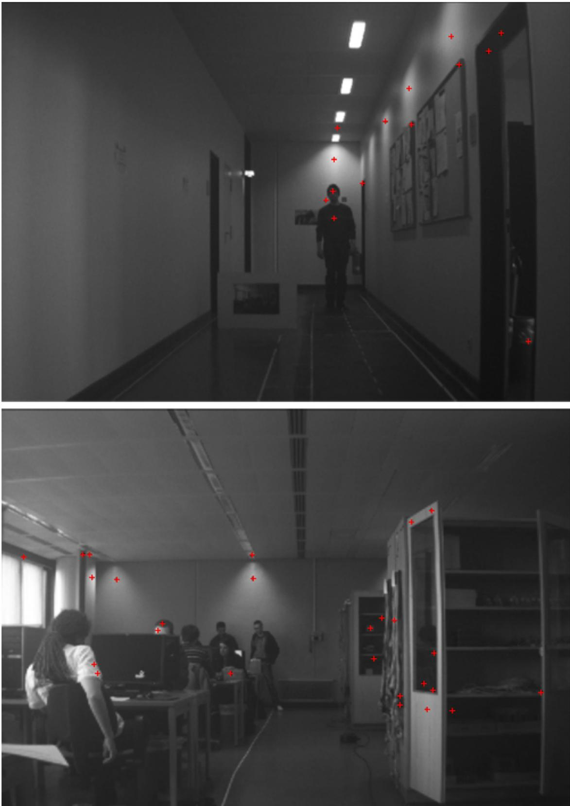
Abbildung 5.17.: Ergebnisbild mit markierten Raumpunkten. Jedes Kreuz markiert einen Bildpunkt, zu dem ein Raumpunkt berechnet werden konnte und somit eine Tiefeninformation vorliegt. Für eine bessere Betrachtung sind die Kreuze rot eingefärbt.
