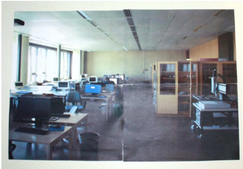
Abbildung 6.1.: Versuchsaufbau der Genauigkeitsanalyse: Holzplatte mit Testbild. Hierfür wurde das Foto eines Labors auf vier DIN A4 Blätter vergrößert und auf einer Holzplatte montiert. Dieser Versuchsaufbau bietet durch die unterschiedlichen Formen und Strukturen eine gute Ausgangsbasis für die Anwendung des SIFT-Algorithmus.
