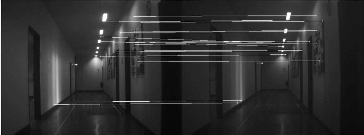
Abbildung 6.7.: Leerer Flur mit SIFT-Punktpaaren (Distanz 20m): Die gefundenen SIFT-Punktpaare befinden sich hauptsächlich im Bereich der Decke oder der rechten Seitenwand. Dies liegt vor allem an dem höheren Kontrast durch die Deckenbeleuchtung und die unterschiedlichen Strukturen der Pinnwände.
