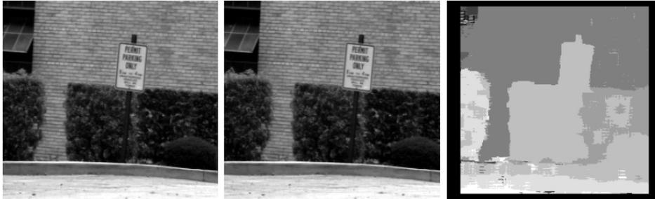
Abbildung 2.2.: Tiefenbild aus Stereobildern (Fusiello u. a. 2000). Beim Tiefenbild (rechts) repräsentieren die unterschiedlichen Graustufen die Entfernung der Objekte zur Kamera.
