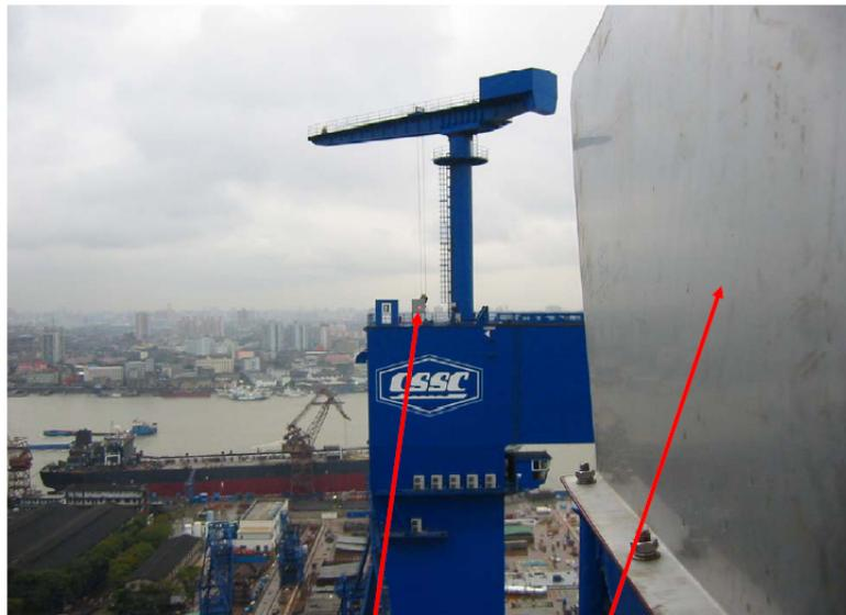
Abbildung 1.1.: Bockkrane im Hafen von Shanghai mit Lasersystem zur Entfernungsmessung (Reflektor (links) und Sensor (rechts)) (Liebske 2005, S. 113).
