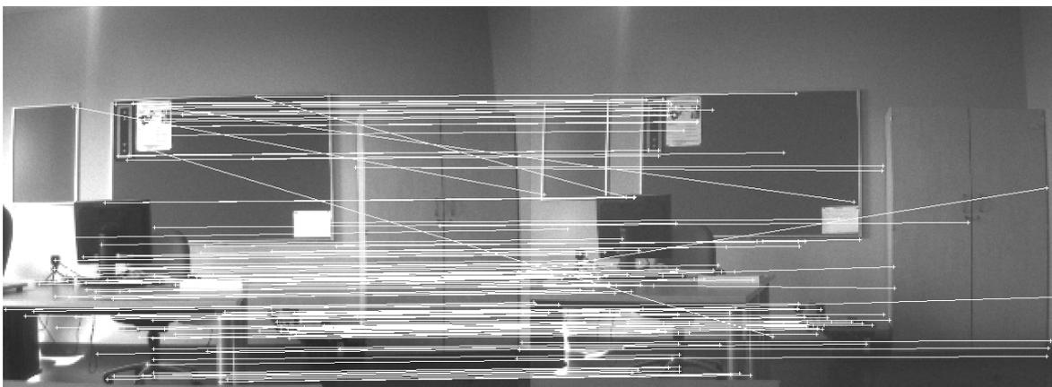
Abbildung 6.13.: Szenario - Arbeitsraum aus statischer Position: Diese Aufnahme simuliert den Blick eines Fahrzeuges in einem Arbeitsraum. Bei dieser Aufnahme steht ebenfalls die Anzahl gefundener SIFT-Punktepaare in einer alltäglichen Umgebung im Vordergrund. Es ist zu erkennen, dass eine große Menge an SIFT-Punktepaaren gefunden wird. Dies wird vor allem durch die Vielzahl der vorhandenen Objekte und andere Lichtverhältnisse begünstigt.
