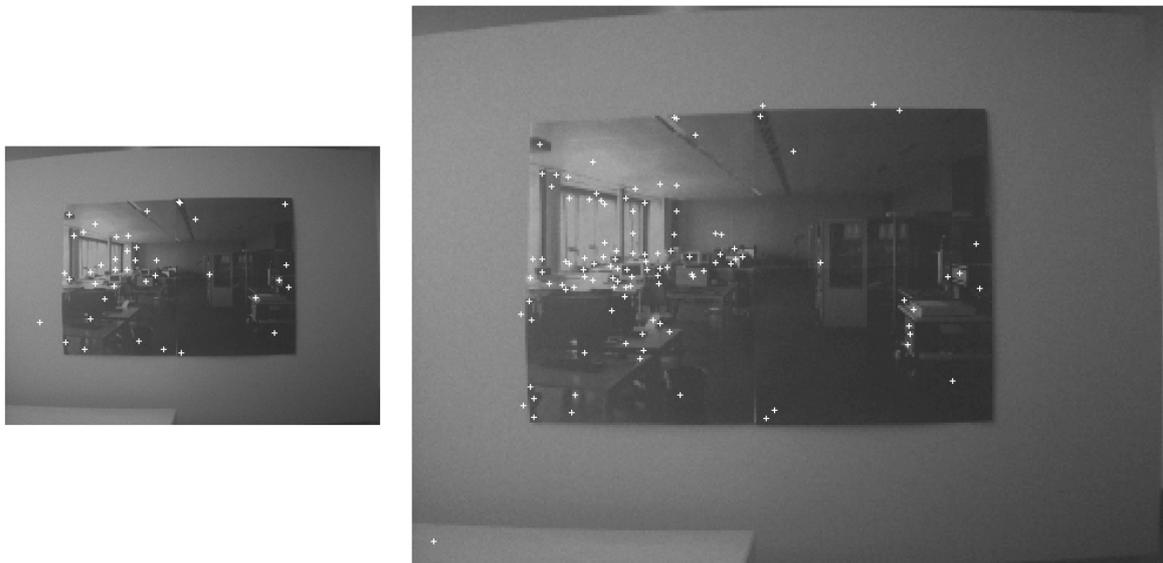
Abbildung 6.18.: SIFT-Punkte mit Downsampling (links) und ohne Downsampling (rechts): Es ist zu erkennen, dass im linken Bild deutlich weniger SIFT-Punkte gefunden werden.
