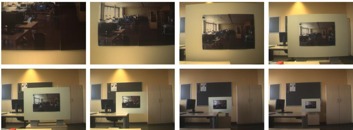
Abbildung 6.2.: Fotoserie der Genauigkeitsanalyse aus Sicht der linken Kamera mit einer Messobjektentfernung von 37 cm (oben links) bis 503 cm (unten rechts).
