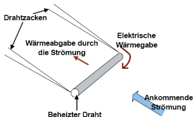
Abb. 2.11 : Messprinzip eines Hitzdrahtes [16]
