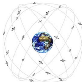
Abbildung 2.3: Umlaufbahnen der GPS-Satelliten
