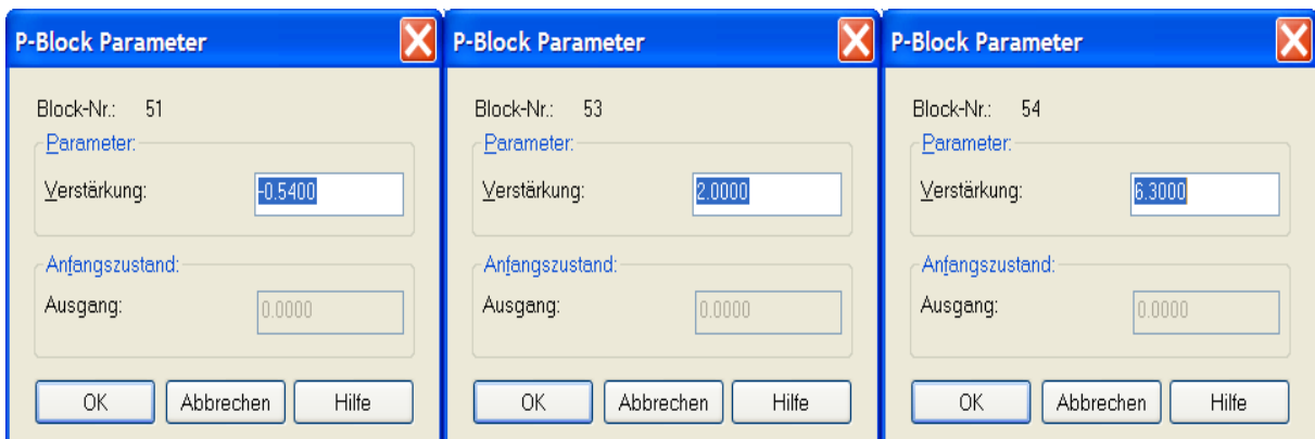
Abb. 75 Einstellung des Rückführvektors
