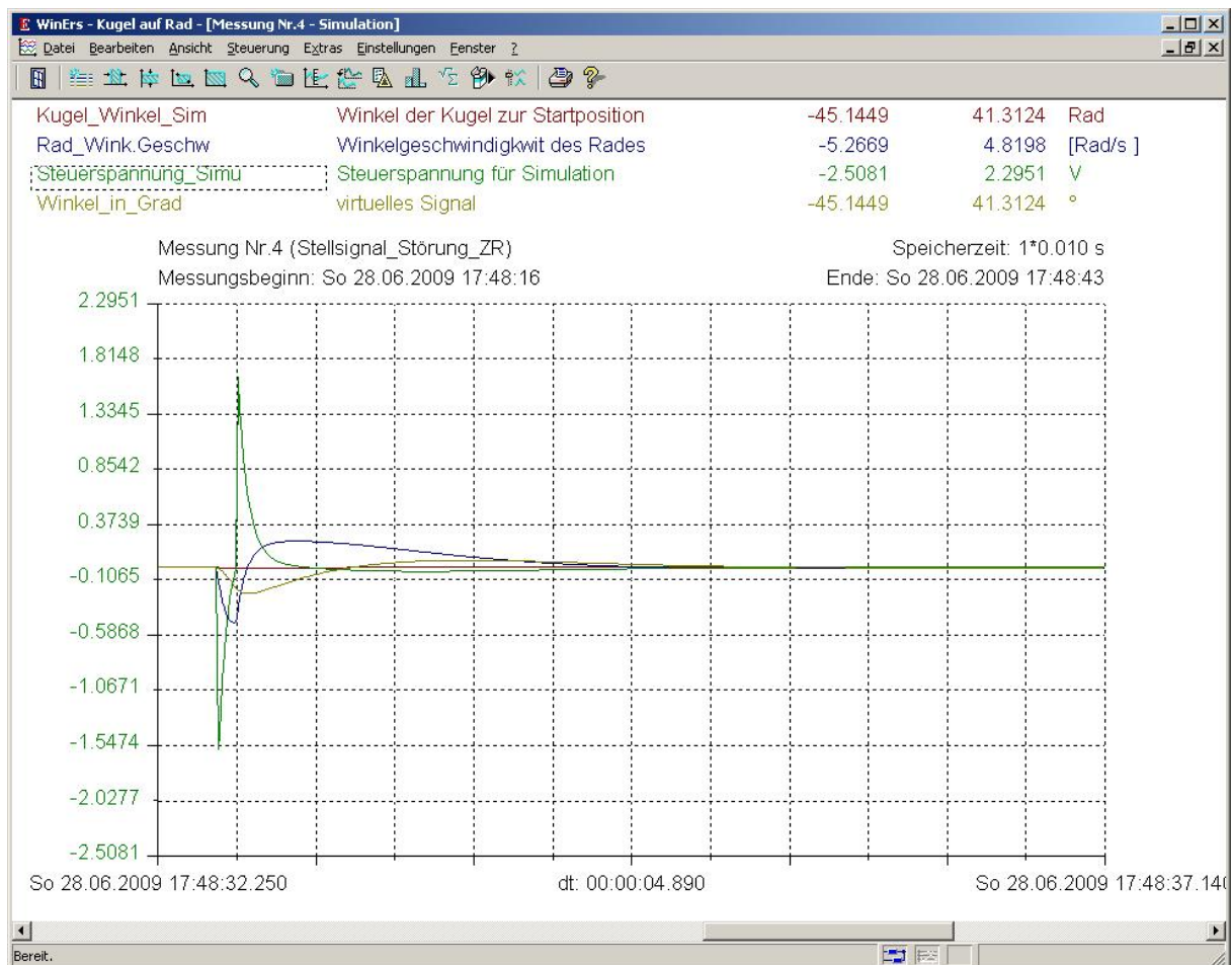
Abb. 77 Antwort des Regelkreises auf einen Störung (Zustandsregler)
