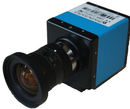
Abbildung 2.6.: Die Kamera DMK 41BF02 mit Objektiv
