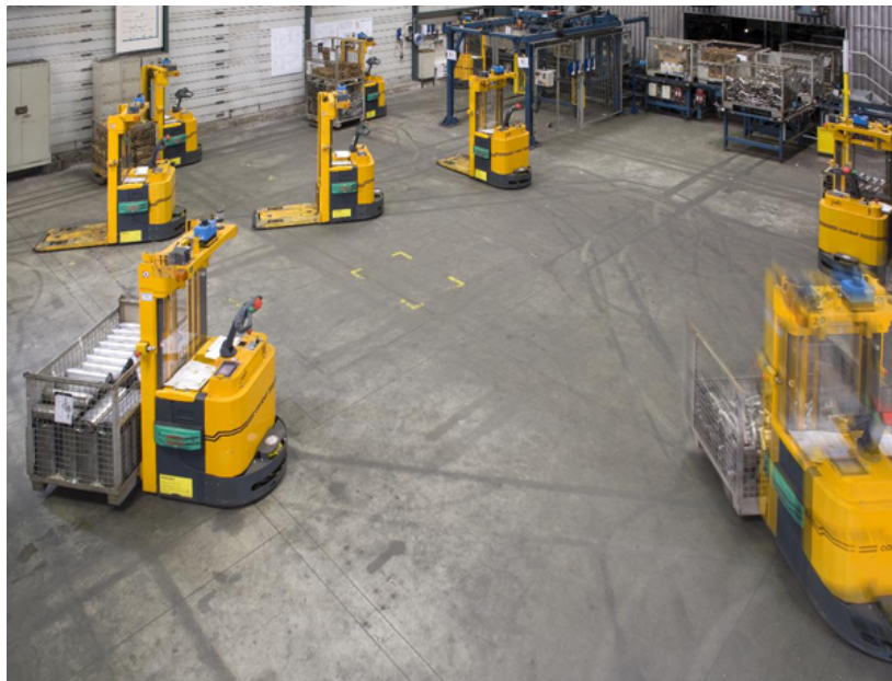
Abbildung 1.1.: fahrerloses Transportsystem „carobot“ der Firma psb ( psb FTS carobot 2007 )
