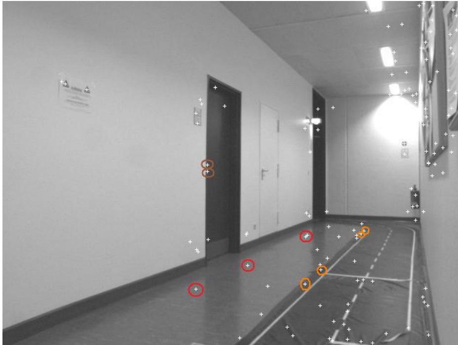
Abbildung 3.11.: SIFT-Punkte mit hohem Verwechslungspotential
