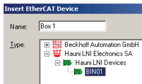
Abbildung 30: Einfügen einer EtherCAT Baugruppe
