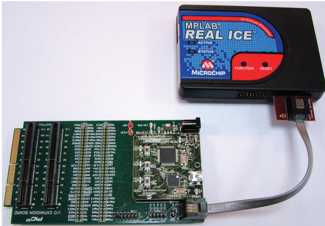
Abbildung 24: PIC32 Starter Kit verbunden mit dem In-Circuit Emulator MPLAB REAL ICE
