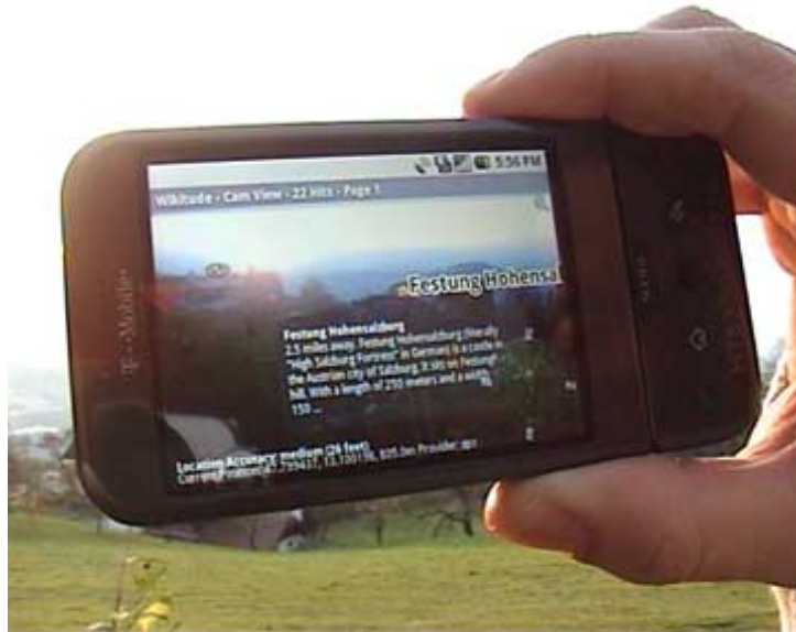
Abbildung 2.4: Augmented Reality-Beispiel "Wikitude AR Travel Guide" auf einem G1 Google Smartphone (Android). Quelle: http://www.mobilizy.com/ .
