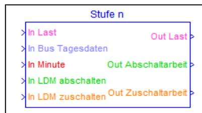
**Abbildung 55: Black Box stufengeschalteter Energieverbraucher**
