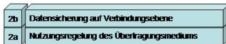
Abbildung 3-6: Teilung der Sicherungsschicht
