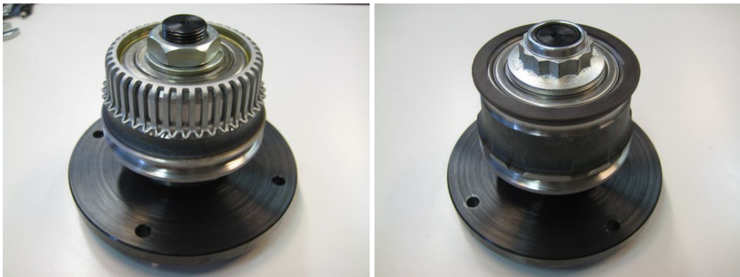
Abbildung 1.4: Links: Radnabe mit passivem Encoder vom VW Golf IV Rechts: Radnabe mit aktiven Encoderring vom VW Golf V
